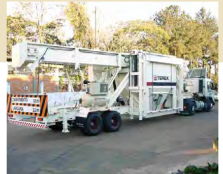
silo móvil autoelevable 25 m 3
