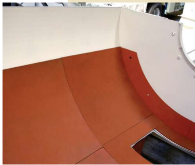
Revestimiento del mezclador
